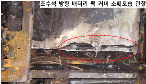
조수석 쪽 배터리팩 내부 배터리 및 금박 이탈
